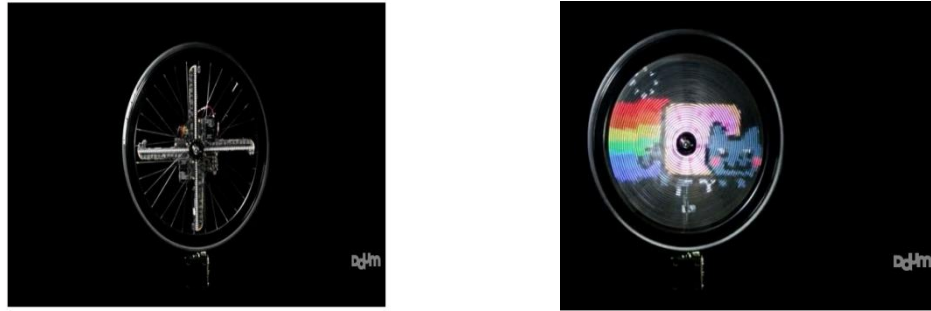
＜LED ランプが装着された自転車の車輪(左)と 車輪の回転を通じて演出される模様及び色彩(右)＞
