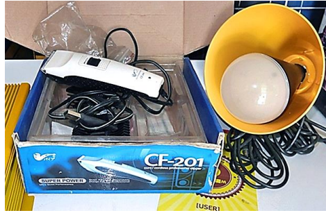
ソーラーで充電できるバリカン。電球とセットになっていて、無電化地域でも床屋を営むことができる。
