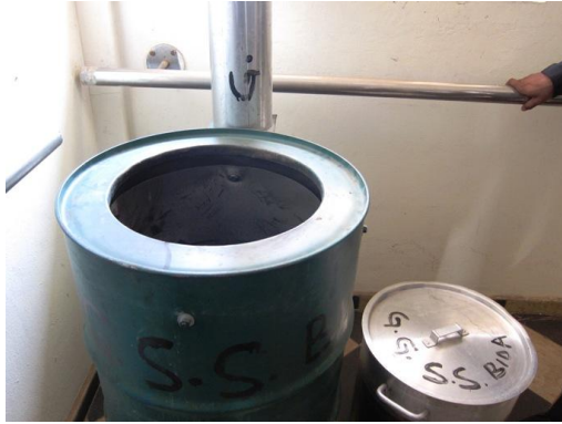
エネルギー関連コンサルティング会社が開発したという簡易型かまど。下から薪をくべるが、かまどには直接火が当たらず、煙が外部に出にくい仕組み。
