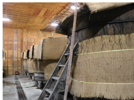
木桶で発酵・熟成させる伝統製法を継承
