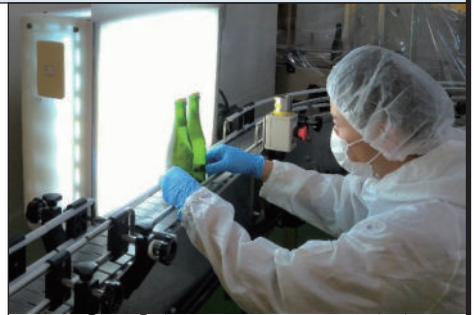
【検品】検品ライトによる目視検査
