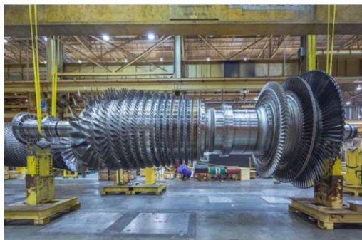
写真 1-3. ガスタービン（GT）外観*
