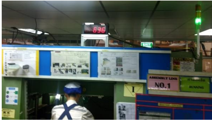
図 5-7 バイブレーションライン 稼働情報デジタルメーター
