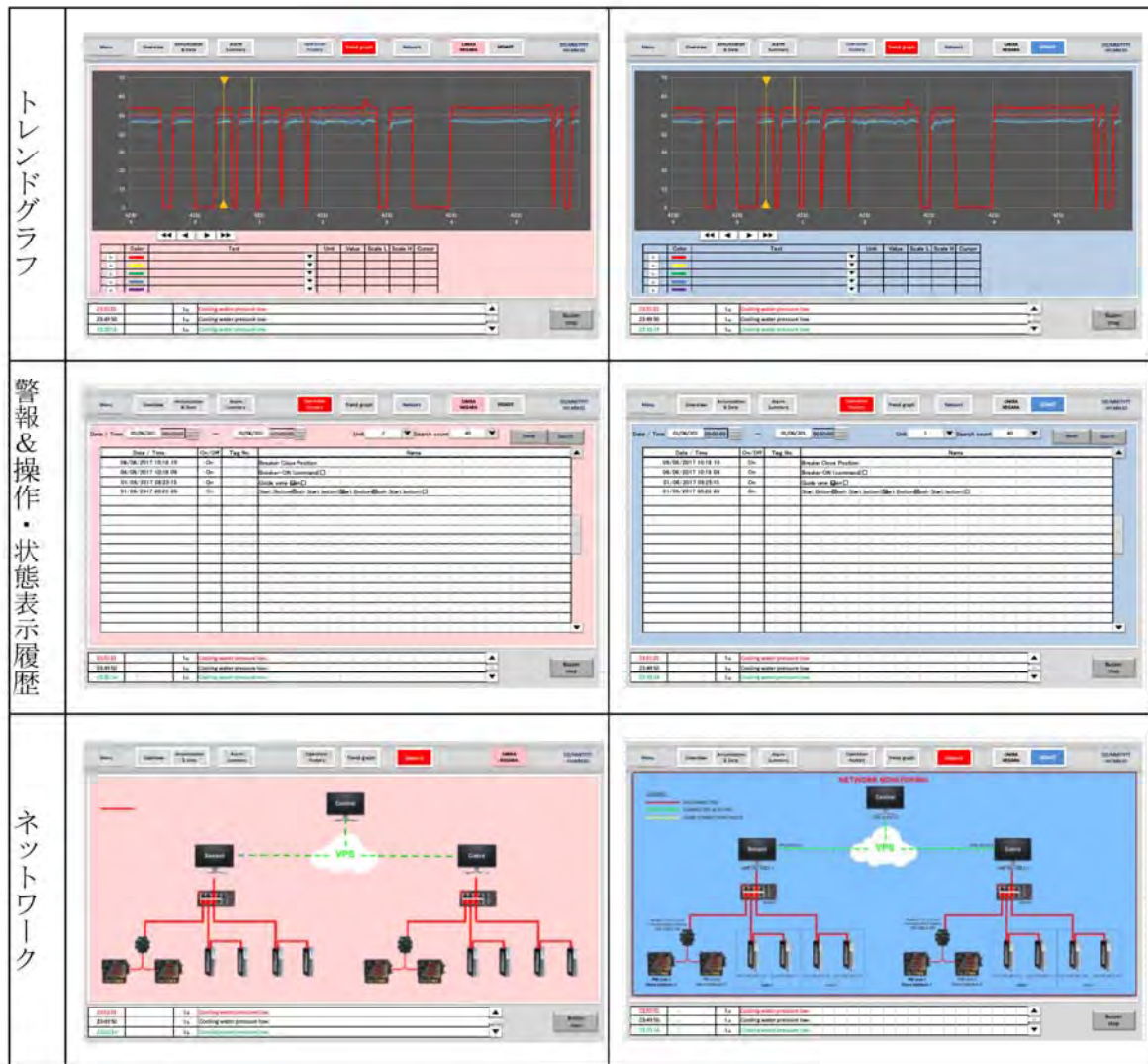
図 6-30 設計した SCADA 画面
