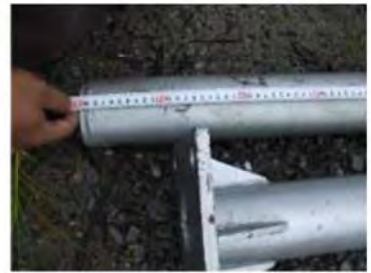
鋼管柱 寸法確認
