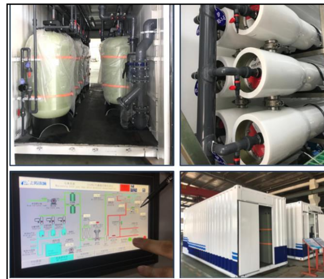
マラッカ州内の島に設置された海水炭化装置
