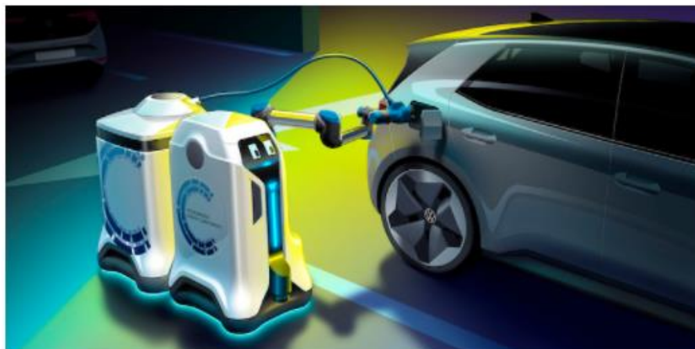
図表 34：モバイル充電ロボットによる自動充電
