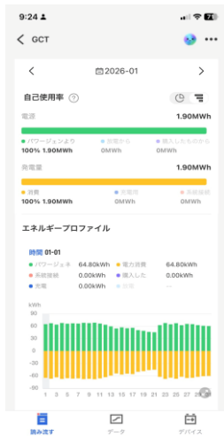
Pemantauan tenaga surya (sekitar 1.900 kWh/bulan)
