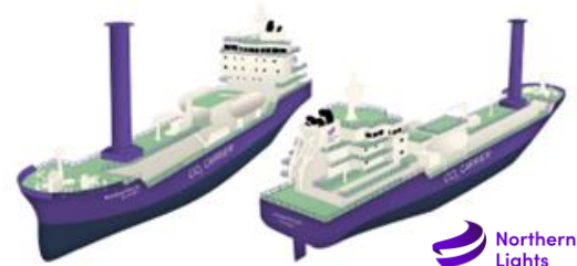
7,500m 3 液化CO 2 輸送船 出典: Northern Lights JV DA
