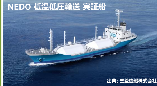
7,500m 3 液化CO 2 輸送船 出典: Northern Lights JV DA
