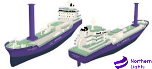
7,500m 3 液化CO 2 輸送船 出典: Northern Lights JV DA
