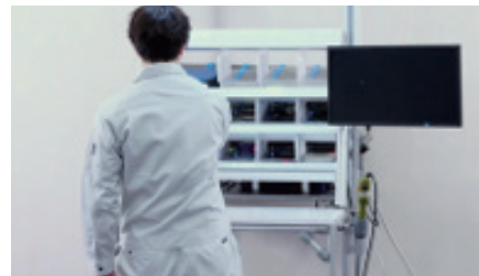
プロジェクションマッピングで作業指示投影
