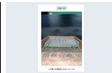
部品をスマホアプリで撮影して自動で数を カウントした後の表示例
