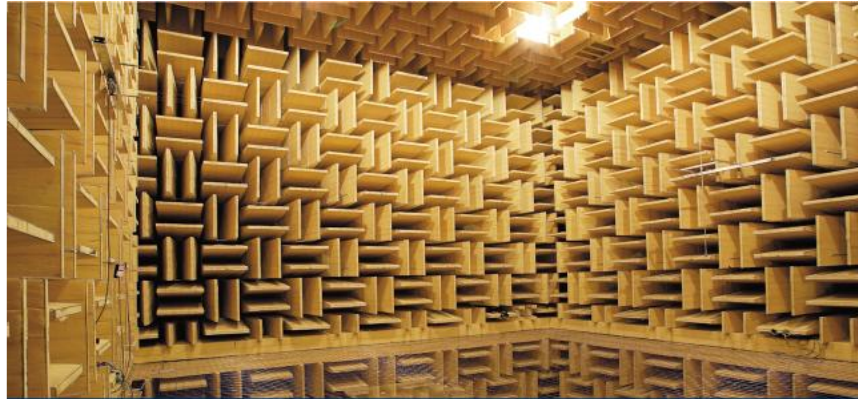
無響室 Anechoic chamber
