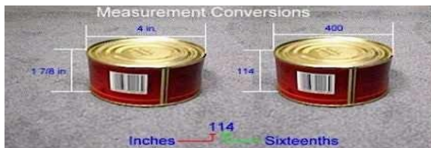
図 38 - 円筒容器の測定
