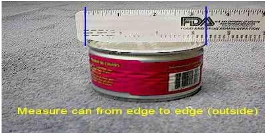
図 41 - 容器の縁から外縁までを測定
