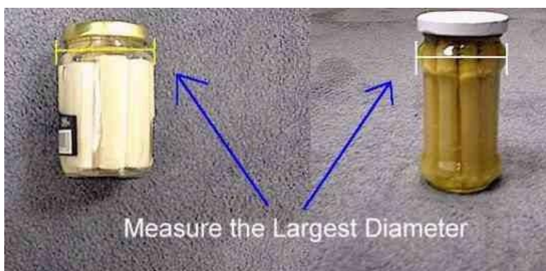
図 39 - 特殊形状の円筒容器の測定
