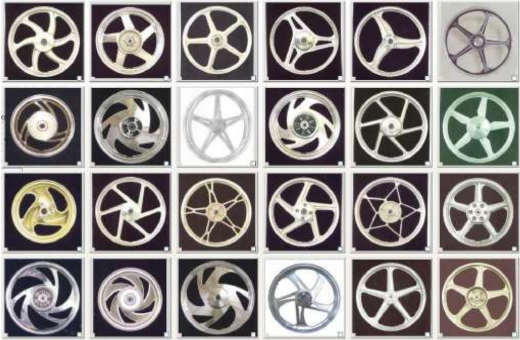
【事例 3-2-10】に示された車輪に関し、上記図は検索により得た複数の既存意匠を示している。既存意匠から見れば、リムの形状は全部円形であり、車輪の形状は転がるという機能に制限されるという認識を裏付けているし、車輪の形状が円形であることは車輪の常套デザインであることを証明している。又、多数の既存意匠から分るように、スポークの形状、数量の変化は様々である。更にスポークのデザイン自由度が比較的大きい、スポークのデザイン変化はリム、こしきのデザインよりも車輪の全体的視覚効果に対する影響が大きい。
