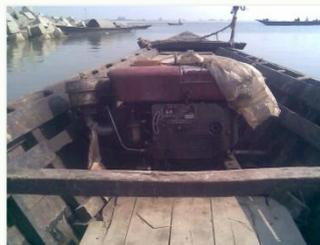
回答者の中には、30,000~50,000タカの漁船に、発動機または船外機を使用していると答えた者もいた。船の価格は大きさによって異なる。機械化された漁船は通常、河川で10~94馬力を持つ。
