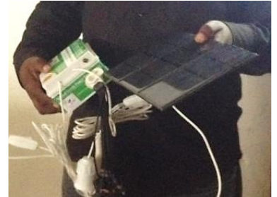
家庭用ソーラー発電システムの蓄電器とソーラーパネル
