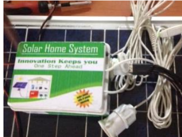
家庭用ソーラー発電システムの蓄電器
