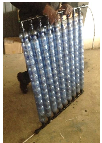
使用後のペットボトルを利用したソーラー温水システム
