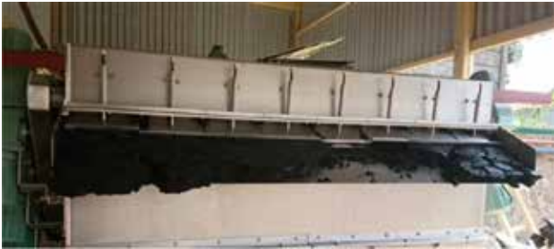
この食品工場は脱水機を有していた。 MT品で脱水試験をしたところ、現行品よりも同添加量で処理性が3倍に向上した。
