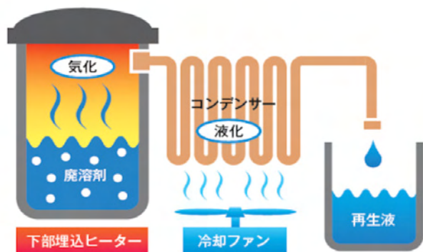
溶剤再生装置の仕組み
