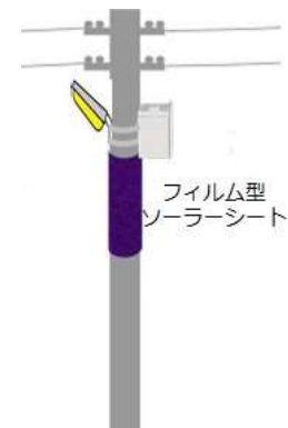
図32. 既設の電柱を利用したソーラー外灯
