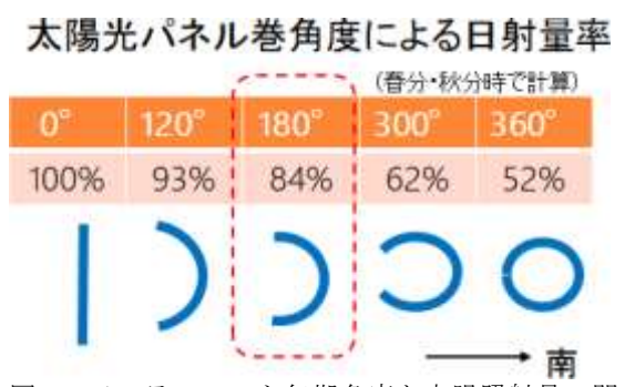
図30. ソーラーシート每期角度と太陽照射量の関係 (Kens.co作成)
