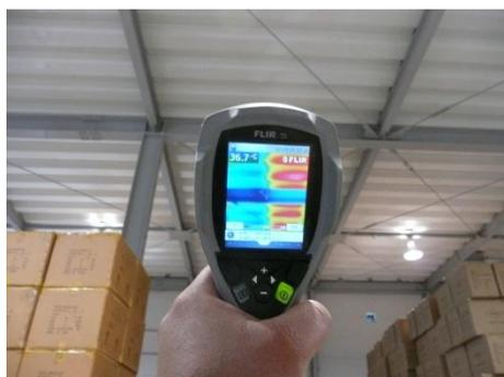
サーモグラフィー撮影 写真左冷えルーフ施工部分 写真右 未施工部分
