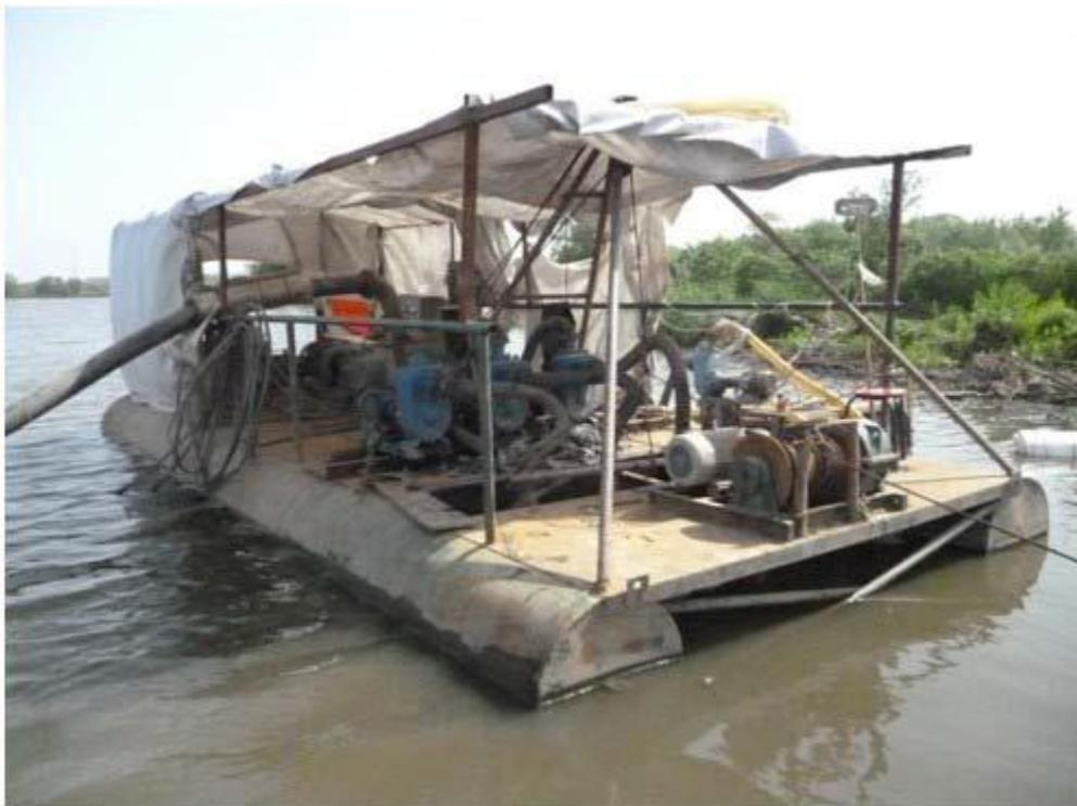
図表 14 南太子湖の浚渫現場写真一遠心脱水機
