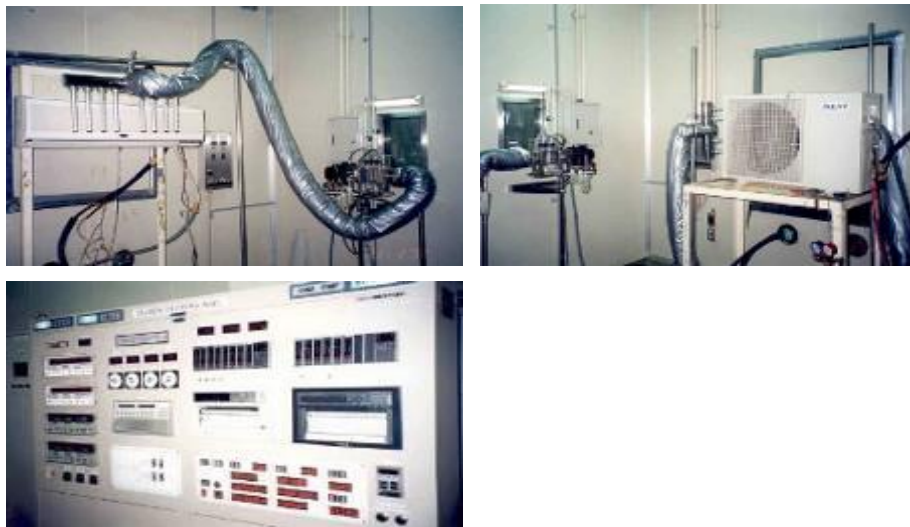
【写真 2-33: エアコンの基準値測定方法】
