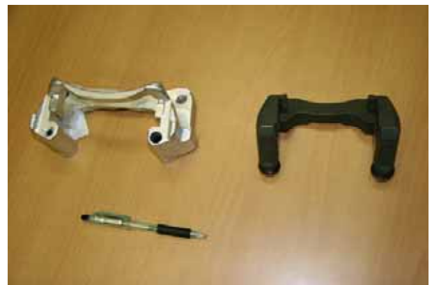
ブレーキキャリパー (左：三価クロム使用、右：六価クロム使用従来品)
