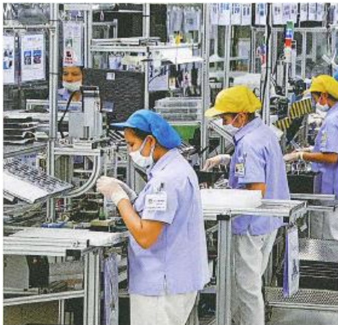
車載オーディオ前面パネルユニット組立ライン 出所: 村元工作所パンフレット
