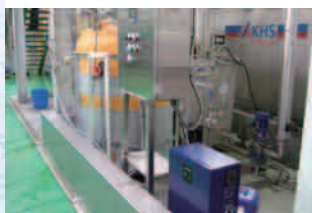
Unité de stérilisation pour le nettoyage d'une ligne de remplissage (modèle 360L/h_Boissons)
