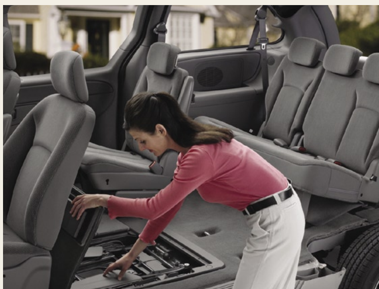
"STOW 'N GO", un des nombreux produits MAGNA pour voitures. La configuration des sièges de 2e rangée permet de dégager un "espace tout plat" en les intégrant au plancher.
