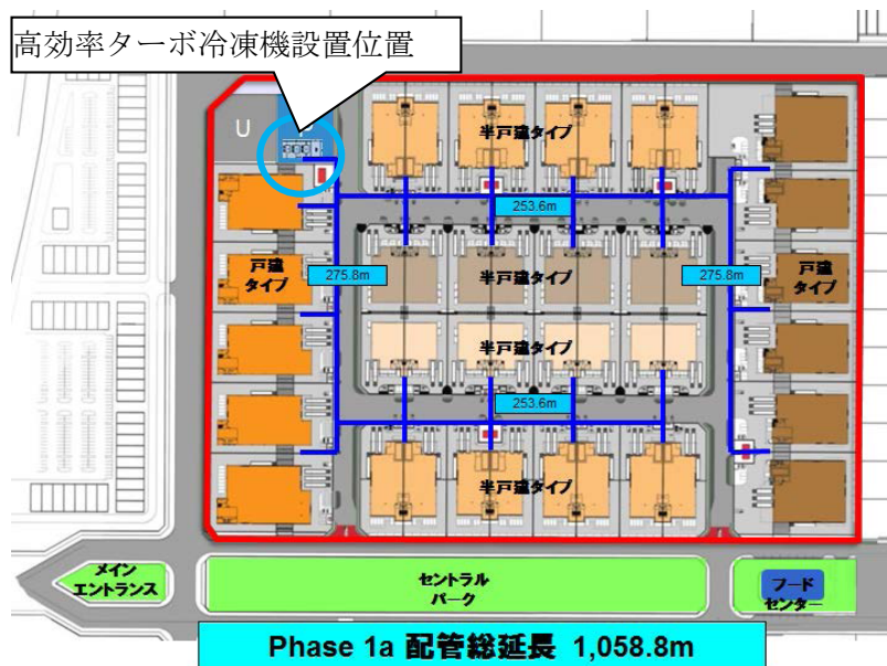
図 4 冷凍機設置位置および配管計画図
