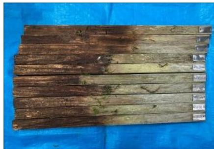
野外防腐試験 マーベルウッド（10年後）
