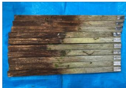
野外防腐試験 マーベルウッド（10年後）
