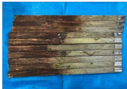
野外防腐試験 マーベルウッド（10年後）
