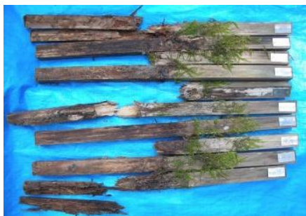
野外防腐試験 他社木材（2年後）
