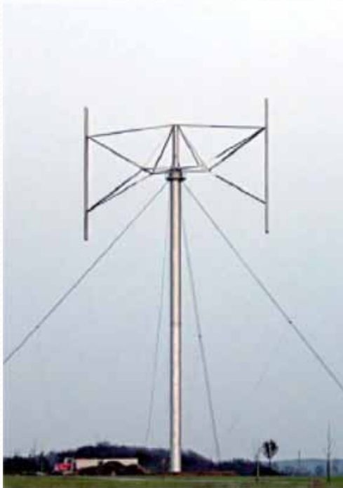
Turbina de viento de eje vertical Tipo Giromill o de palas verticales
