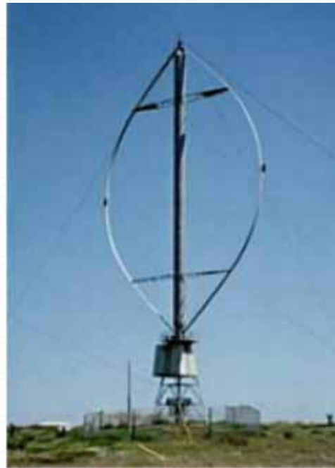
Turbina de viento de eje vertical Tipo Darrieus
