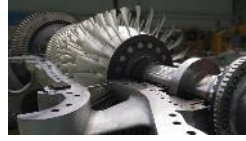
アンモニア焼きガスタービン
