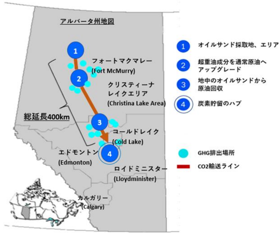
図3 パスウェイズ・アライアンスの炭素貯留地に向けたCO 2 輸送図
