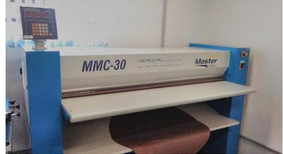
写真4 面積測量機器
