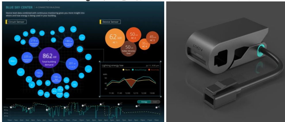
図表 7: Verdigris 社の電力管理画面(左)と小型センサー(右)
