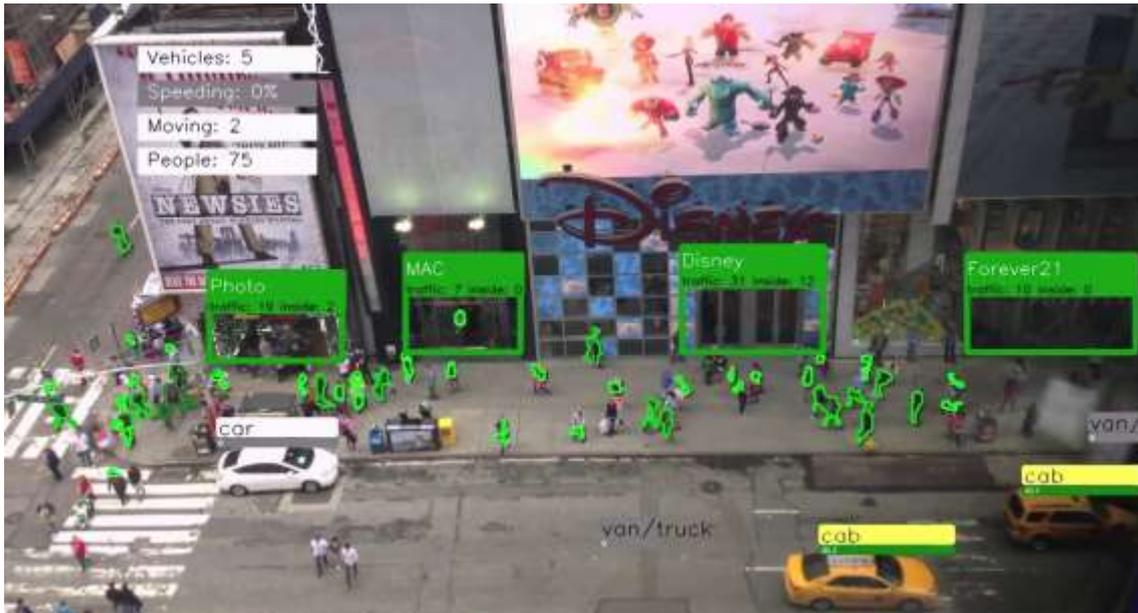
街中の交通状況を画像認識で計測している様子（プレースメーター提供）
