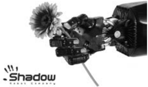
遠隔操作で動くロボット・アーム（写真提供：Shadow Robot Company）
