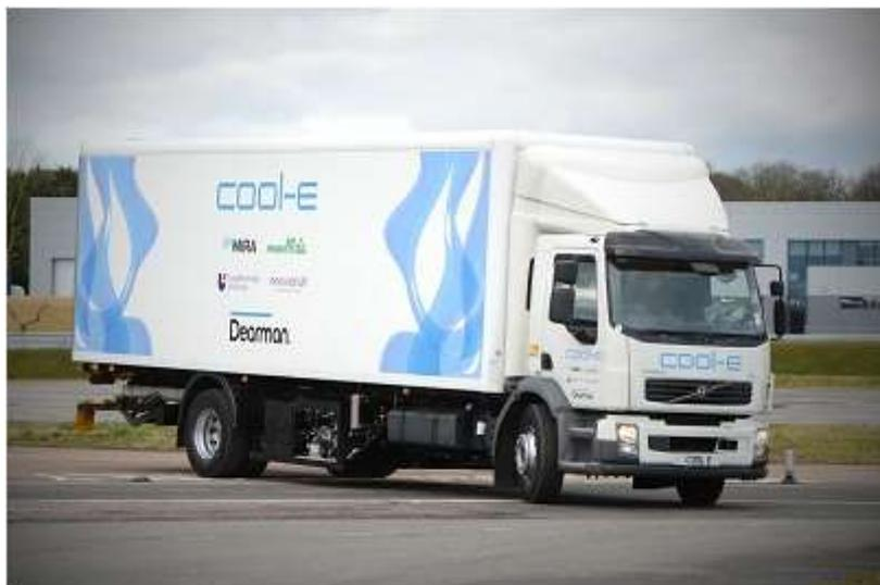
走行実験中の液体窒素発動機搭載トラック(ディアマン提供)
