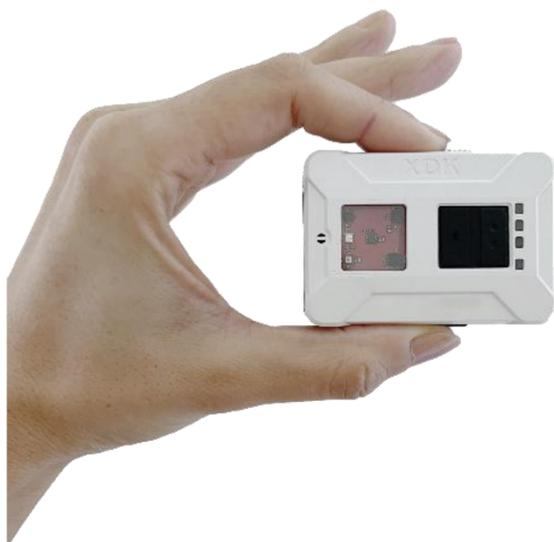
ロブスター（製品）はスマートウォッチによく似ていますが、唯一の違いは産業機器用に設計されているということです。ロブスターには、振動・磁場・角速度・温度・湿度・光度などの8つのセンサーが搭載されています。当社のAIモデルが、ロブスターから送られてくる高周波信号や連続信号をリアルタイムで分析し、性能・品質・エネルギー消費の異常を検出します。
