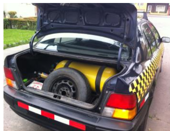
ディーゼル車改造 LPG 車のタクシー。DDF(ディーゼル・デュアル・フューエル)システムが普及している。改造費用は約 1,250 ドル
