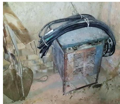
ロシア製の溶接機器。220Vと380Vに対応している。
