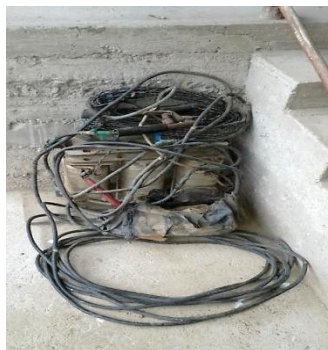
ロシア製の溶接機器。220Vと380Vに対応している。
