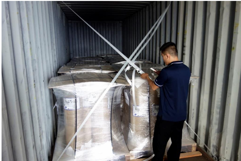
図 6-5 コンテナ内のラッシング*の様子
