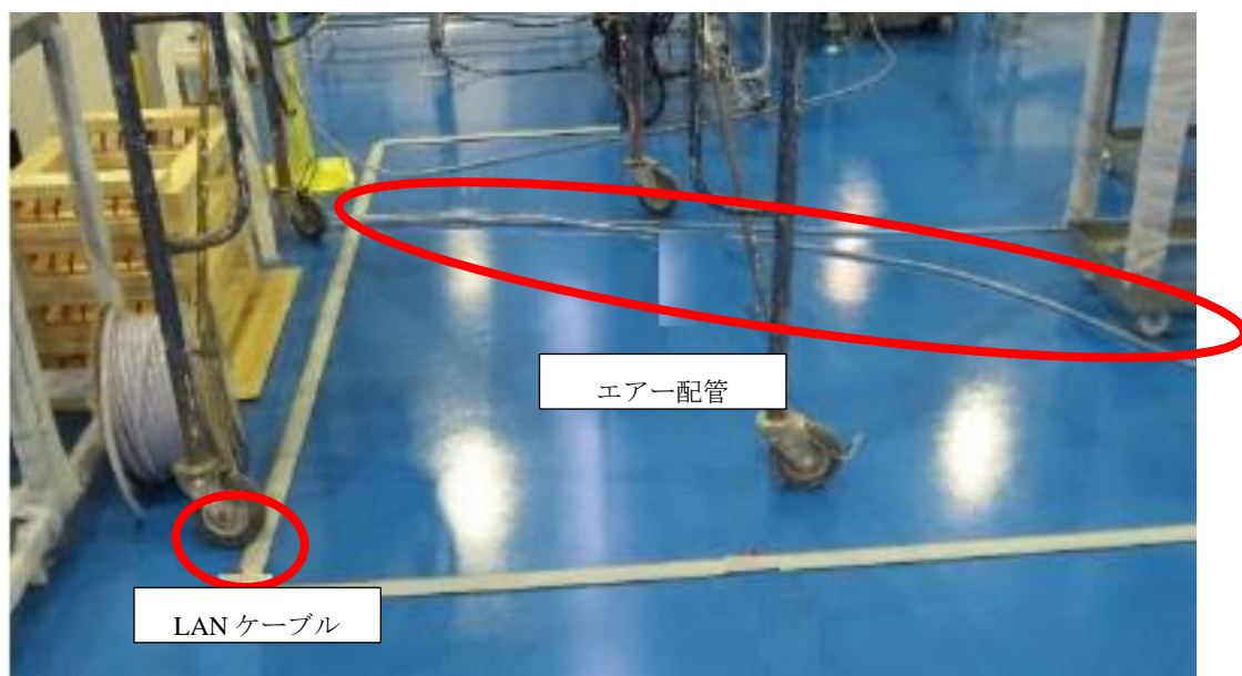
図 5-53 配管、配線の障害
