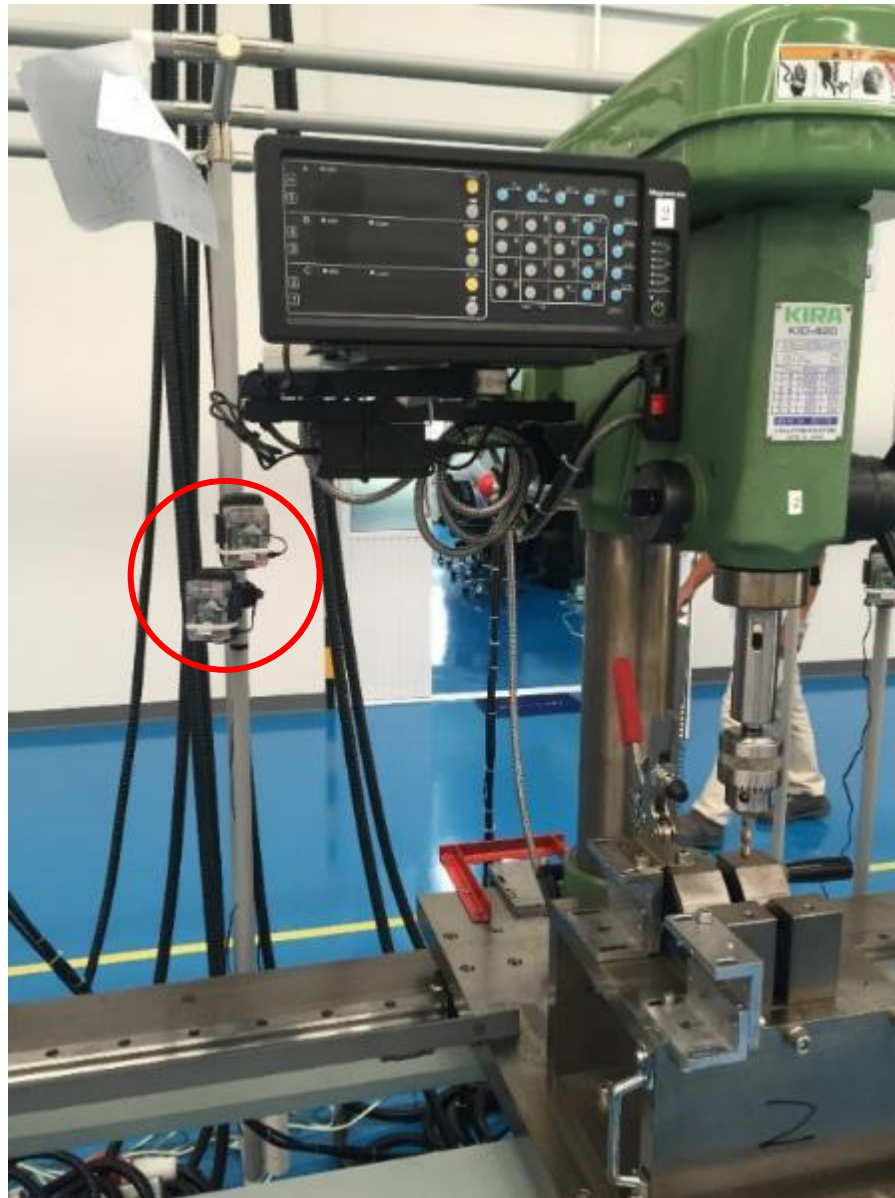
図 5-33 ハンドレール工程に取り付けた Raspberry Pi (赤丸で表示)
