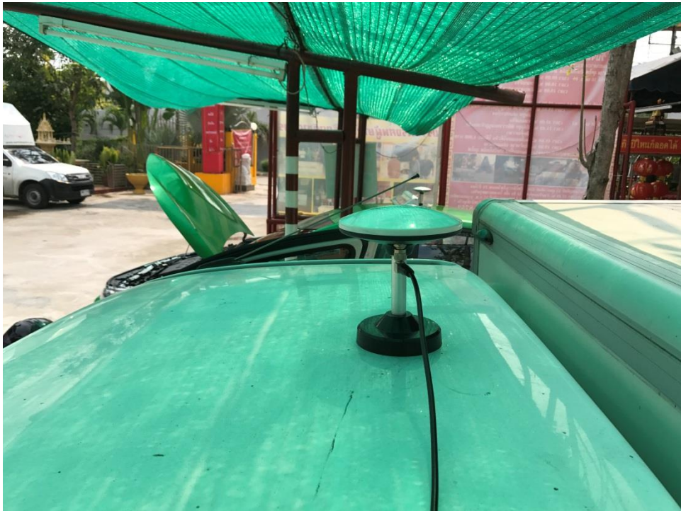
図 5.2.2-3 トラックにおけるマルチ GNSS 受信機用アンテナ設置の様子
