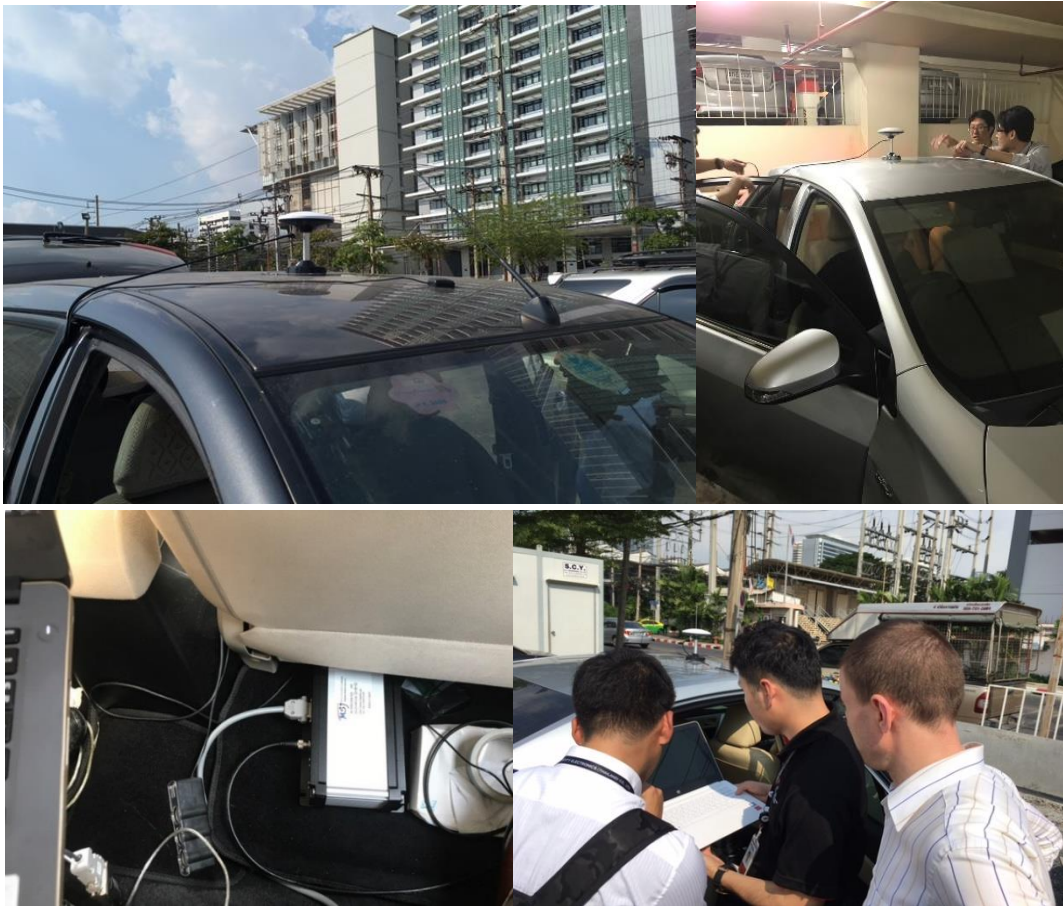
(左上、右上：アンテナの取付、左下：車内受信機系取付、右下：停止時の受信機系動作確認)
