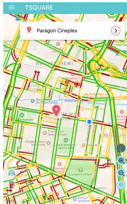
図 6.2.1-3 スマートフォン向け配信サービスのユーザインタフェース (道路上の赤が Jam、黄が Slow、緑が Smooth)
