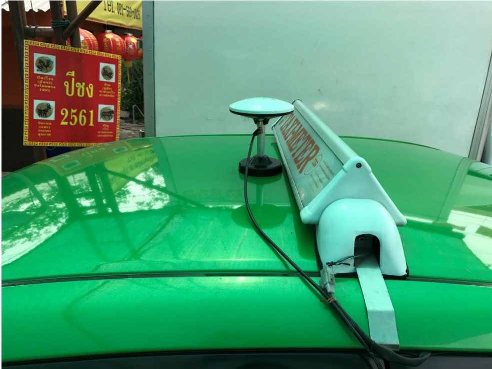
図 5.2.2-2 タクシーにおけるマルチ GNSS 受信機用アンテナ設置の様子
